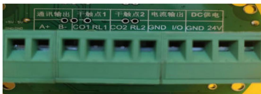
电源：220VAC或DC24V，订货时告知；输出信号：4~20mA；RS-485：A B;两路继电器分别：干触点1为第一路，干触点2为第二路。
