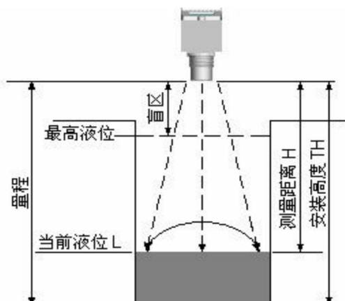
如左图所示，仪表的探头发波打到液位后反射回探头，探头接收到后计算发波到收波的时间，得到测量距离L，仪表安装高度TH减去测量距离L将得到当前液位H。
