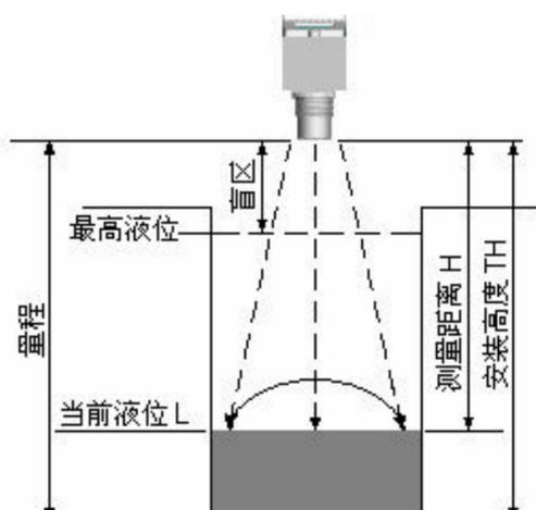
如左图所示，仪表的探头发波打到液位后反射回探头，探头接收到后计算发波到收波的时间，得到测量距离H，仪表安装高度TH减去测量距离H将得到当前液位L。
